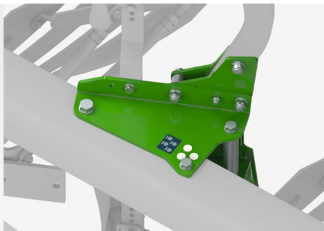
Réglage mécanique de la largeur de travail
